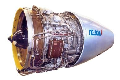
На базе дв. ПС-90А разработан и сертифицирован дв. ПС-90А1 с серийным немодифицированным вентилятором с тягой на взлетном режиме 17,4 тс при  $t_H \le +25$ °C,  $P_H = 760$  мм рт. ст.
